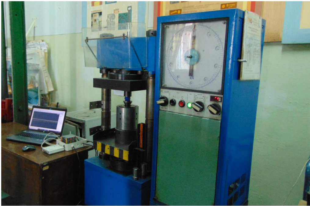
Рис. 2.4 – Схема експериментального стенду на базі випробувальної машини МС500, АЦП, тензометричної апаратури і ПК
